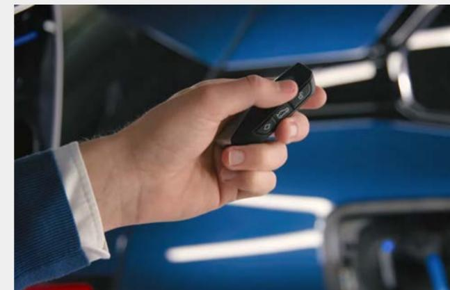
5. Une fois la recharge terminée, déverrouiller le véhicule pour débrancher le chargeur.
