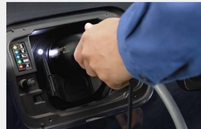
5. Brancher le câble de recharge dans la trappe de recharge du véhicule.
