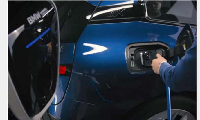
3. Brancher le câble de recharge dans la trappe de recharge du véhicule pour lancer la recharge.
