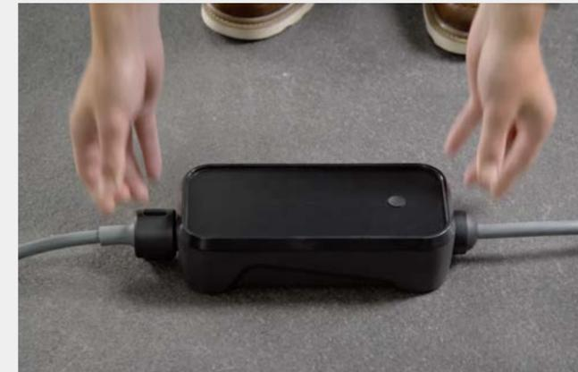
2. Placer l'unité de charge sur le sol ou utiliser le kit de montage mural pour l'accrocher au mur.
