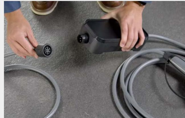
1. Brancher le câble d'adaptateur correspondant à la prise de courant à l'unité de charge.
