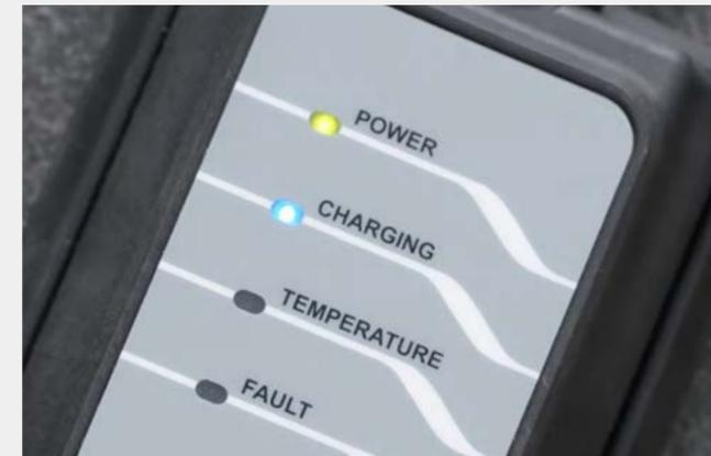
5. Le témoin bleu à DEL de l'unité de charge indique que le véhicule est en charge.
