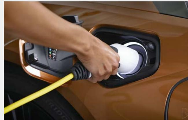
4. Brancher le câble de recharge à la trappe de recharge du véhicule.
